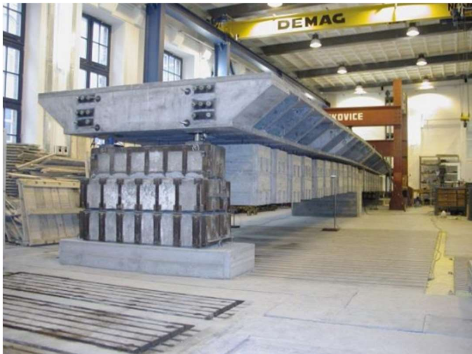
Obrázek 1.4 – Varianta zatížení – kusové závaží zavěšené – betonové kvádry [27]
