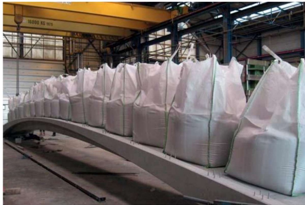
Obrázek 1.5 – Varianta zatížení – kusové závaží volně položené – pytle s pískem [24]
