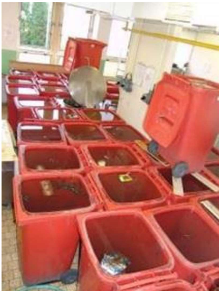
Obrázek 1.6 – Varianta zatížení – popelnice naplněné vodou [18]
