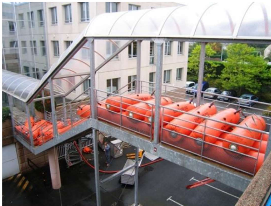
Obrázek 1.7 – Varianta zatížení – vodní vaky od firmy Proofload [31]
