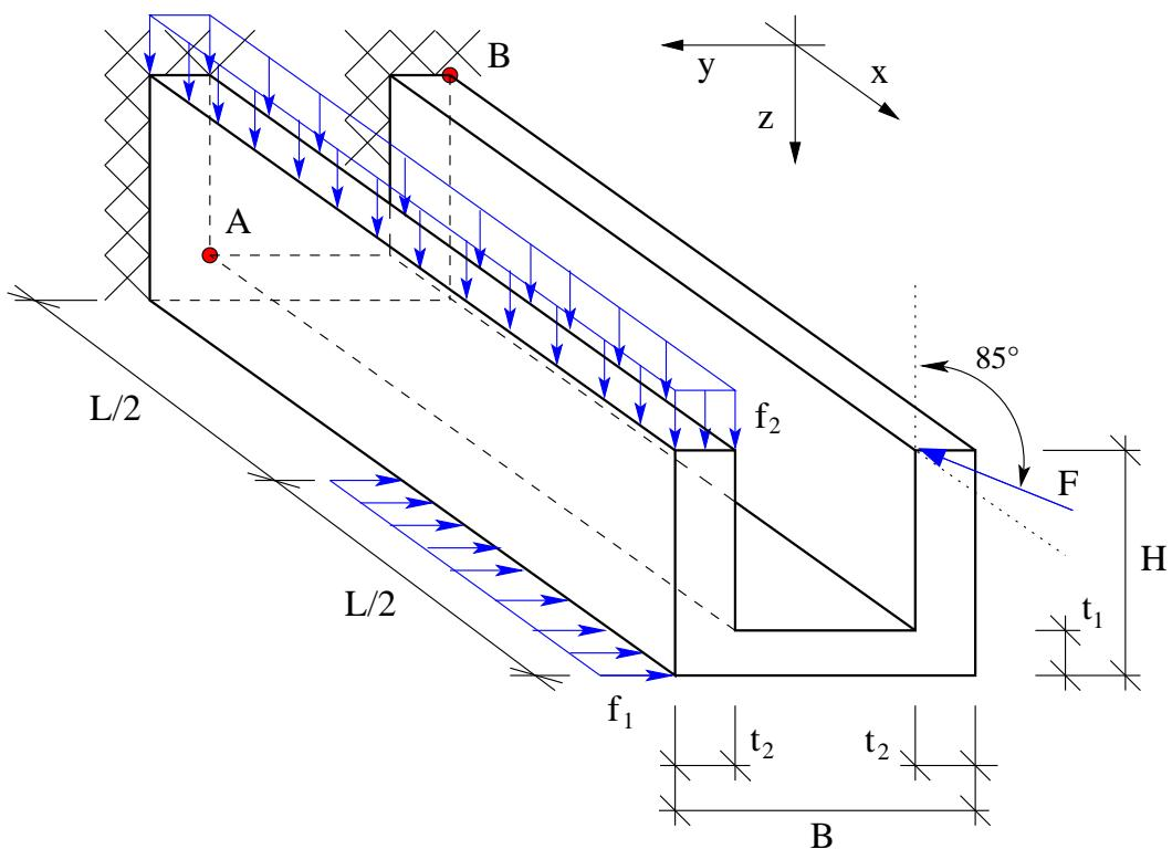
Konzola s průřezem ve tvaru U je zatížena silou  $F = 200(a + b + c)$  kN, působící v rovině  $xz$ , vodorovným liniovým zatížením o intenzitě  $f_1 = 20a$  kN/m a svislým plošným zatížením o velikosti  $f_2 = 30b$  kN/m<sup>2</sup>. Paprsek síly  $F$  svírá s osou  $z$  úhel  $85^\circ$ .
